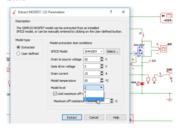
Buck Converter Schematic をクリックしてダウンロードします。この回路図では、MOSFET モデル Q1 はレベル 2 に変更されています。
