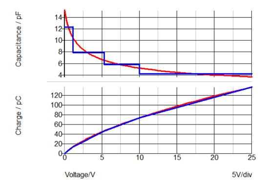
上のグラフは、この例のダイオードの逆電圧に対する容量を示します。赤色の曲線は SPICE モデルの連続的変化を表し、青色の曲線は SIMPLIS モデルの階段状変化を表します。
